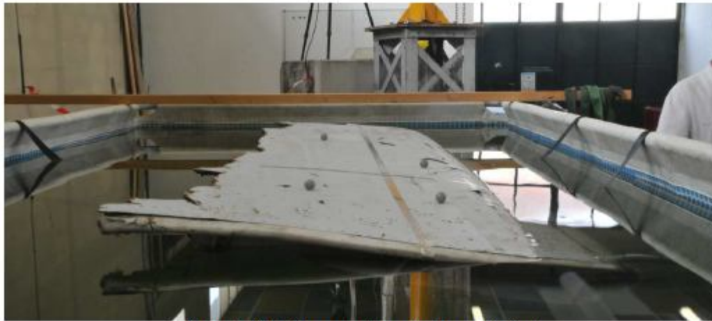
Figure 5 : Equilibre en surface, extrados vers le haut
