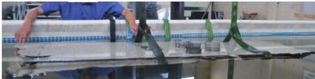
Figure 6 : Immersion complète, intrados vers le haut
