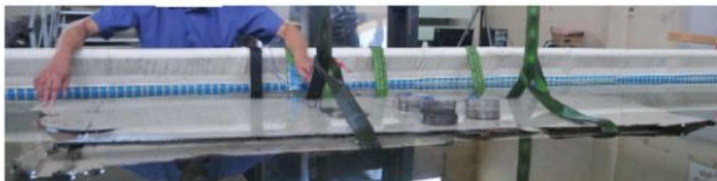
Figure 11 : Immersion complète, intrados vers le haut
