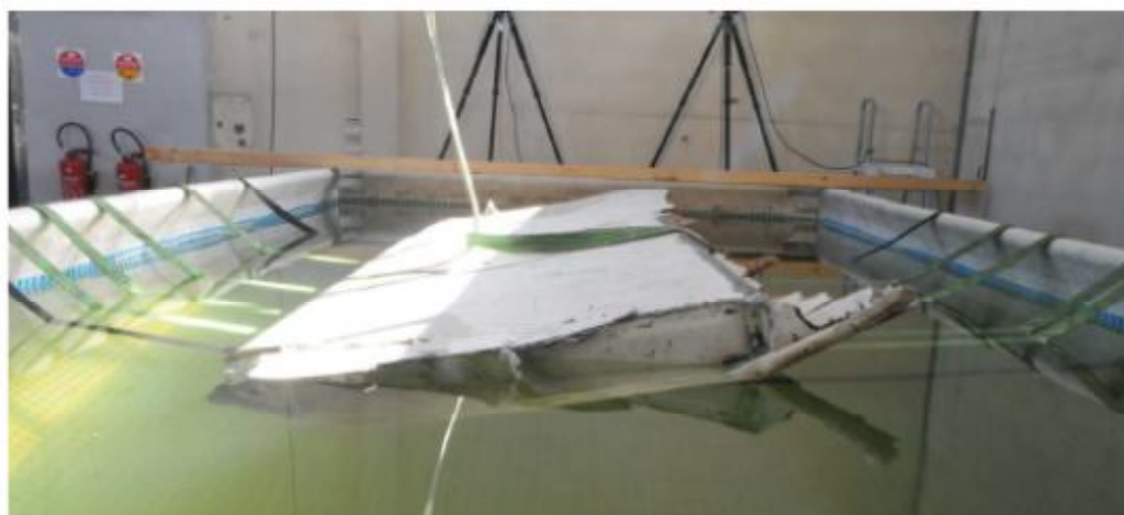
Figure 4 : Equilibre en surface, intrados vers le haut
